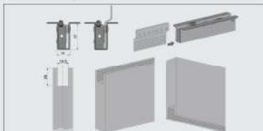
۴. مطابق تصویر بر اساس بازشو فرقره بالا و پایین را در جهت مناسب نصب نمایید و سپس درب را نصب کرده و ریگلاژ نمایید.
