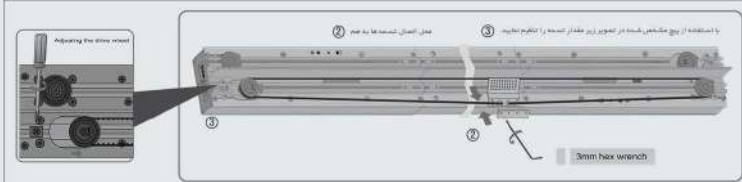
۲. تسمه بین موتور اصلی و هرزگرد را نصب کنید، سپس پروفیل بالا و پایین را در محل مورد نظر نصب نمایید.
