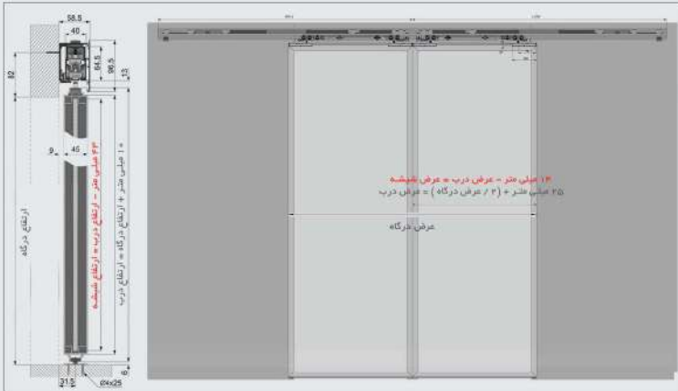
۱. مطابق تصویر زیر پروفیل های دور درب را نصب کنید.
