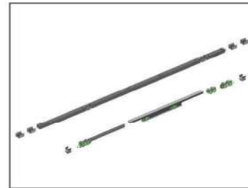
۱. مطابق تصویر زیر پروفیل های دور درب را نصب کنید.
